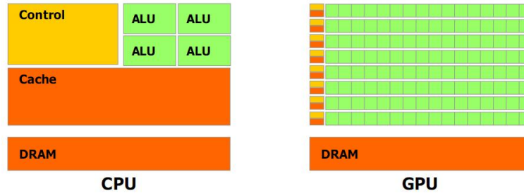
Abbildung 1.1: Unterschiedliche Strukturen zwischen CPU und GPU Quelle: [CUDAGuide]
