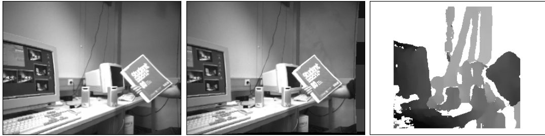
Abbildung A.2: Linkes und rechtes Kamerabild, sowie das daraus errechnete Disparitätenbild
