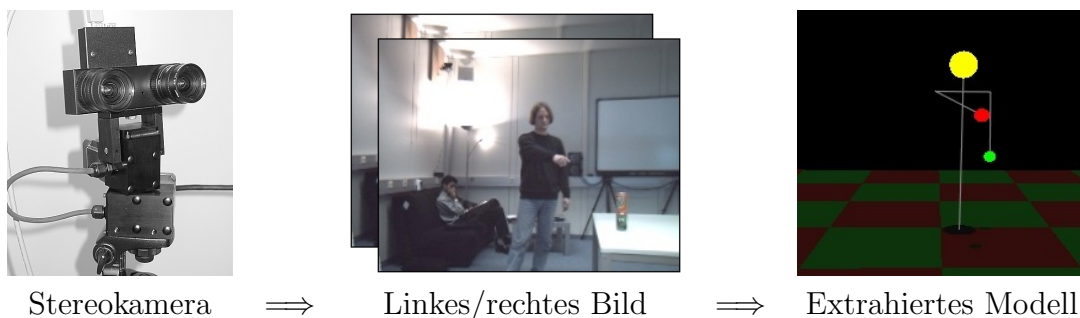
Abbildung 2.1: Eine Stereokamera liefert kontinuierlich Bildpaare, aus denen die Positionen von Kopf und Händen extrahiert werden.
