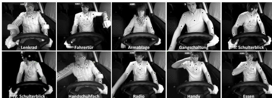
Abbildung 4: Erfassung der Oberkörperpose bei zehn Fahreraktivitäten. Die Punkte zeigen die erfassten Positionen, die zurück von der 3D-Position in das Aufnahmebild projiziert wurden.
